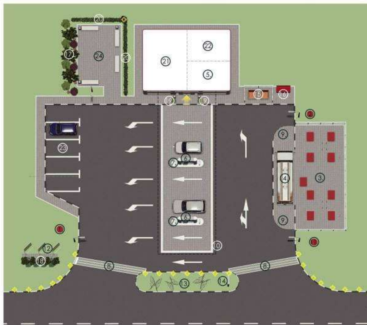
Тип 1.2. Схема планировочной организации придорожной автомобильно-заправочной станции
